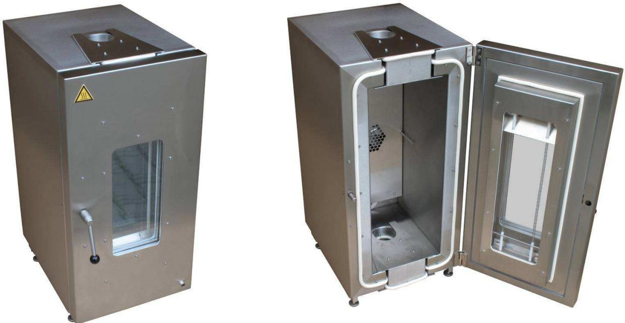
Die Temperaturkammer MS2700 wurde für den Einsatz in Zugprüfmaschinen konzipiert und hat entsprechend oben und unten eine Durchgangsöffnung für die Spannzeugadapter. Sie ist komplett aus Edelstahl und für einen Temperaturbereich von  $-55^{\circ}\text{C}$  bis  $+260^{\circ}\text{C}$  ausgelegt. Geregelt wird die Kammer mit einem elektronischen Regler auf  $\pm 0,1^{\circ}\text{C}$ .
