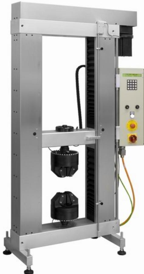
Die zweisäuligen mikroprozessorgesteuerten Zugprüfmaschinen der Baureihe T2000, T3000 und T5000 sind für Zug-, Druck- und Biegeprüfungen bis 20kN, 30kN und 50kN konzipiert worden. Durch die robuste Konstruktion aus Aluminium und Edelstahl sowie der kompletten Spindelverkleidung finden die Maschinen ihren Einsatz sowohl im Prüflabor, wie auch in rauer Produktionsumgebung.
